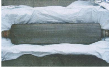
(2) Lower Corr Roll ลอน C น้ำหนัก 750 กิโลกรัม เส้นผ่านศูนย์กลาง 25 เซนติเมตร ความยาว 187 เซนติเมตร
