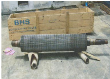
(2) Lower Corr Roll ลอน C น้ำหนัก 750 กิโลกรัม เส้นผ่านศูนย์กลาง 25 เซนติเมตร ความยาว 187 เซนติเมตร
